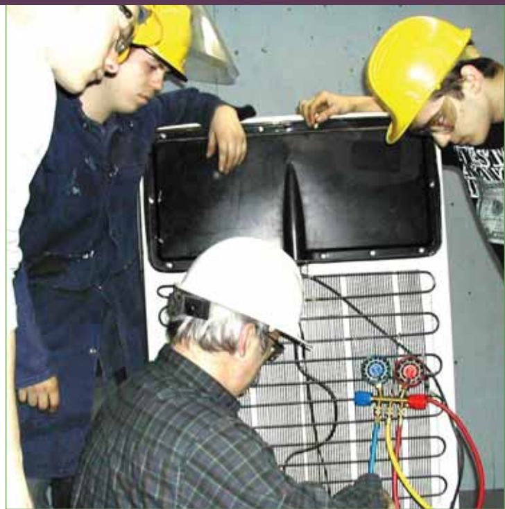
Procédé d'extraction d'halocarbures
